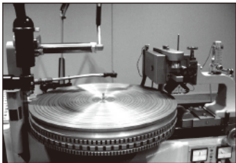
カッティングマシン：ドイツのノイマン社製。世界に数台しか残っていない。これで音を刻み込む。(写真はラッカー盤が載っていない状態)
