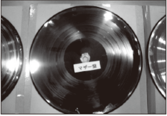
④マザー盤(凹)：③をメッキして剥がしたもの。これで音のチェックをし、OKの場合は次の工程に進む。
