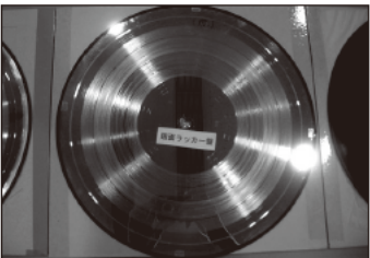
②銀面ラッカー盤(凹)：①に銀を塗布したもの。型を作る時電気でメッキするために銀を塗付する。厚みは500オングストローム。
