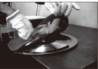
凸と凹が剥がれる瞬間。ニッケルで包まれた盤を真ん中からベリッとはがす。
