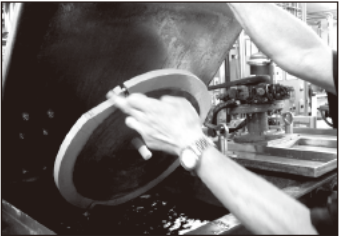
これがメッキ槽。回転しながらニッケルを付着させる。
