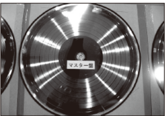
③マスター盤(凸)：②を回転メッキ槽に入れてニッケルをメッキ。メッキの層を剥がすことができる。プレス用の型として使えるが、②からは一枚しか出来ず、壊れるとまたカッティングしなきゃなので、次の工程に進みます。
