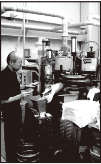
プレスマシン：⑤のスタンパー(凸)で、紙のレーベル、塩化ビニルのレコード原料を挟み込んでプレス。30秒間で1枚できる。
